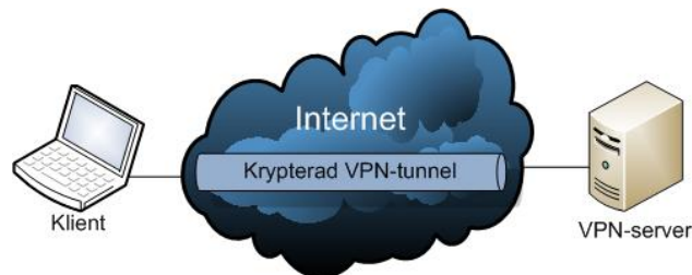
Figur 7: Visar en VPN-tunnel över internet
